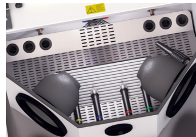
Ergonomische Strahlgriffel und separate Ausblasdüse
