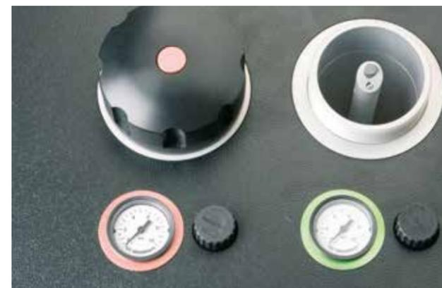
Strahlkammern mit individuellem Arbeitsdruck, 1-6 bar
