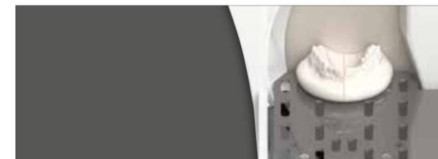
**Richtlicht:** Kombination aus Tageslicht-LED und Laser, präzise und ohne Blendung oder Reflektionen, Ausrichtung der Raphe-Median-Linie zur Laserlinie ermöglicht genaues Beschleife der OK-Tuberebene.
