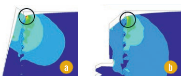
Bild 2: Spannungsreduzierung durch 45 Grad Konuswinkel; a) 45° Konus, b) kleiner Konuswinkel
